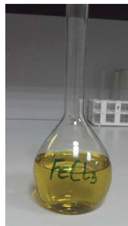
Fot. 2b) Chlorek żelaza (III) po dodaniu wodnego roztworu kwasu solnego (kolba 2) (fot. A. Szychowska) Photo 2b) Iron chloride (III) after the addition of aqueous solution of hydrochloric acid (flask2) (Photo. A. Szychowska)
